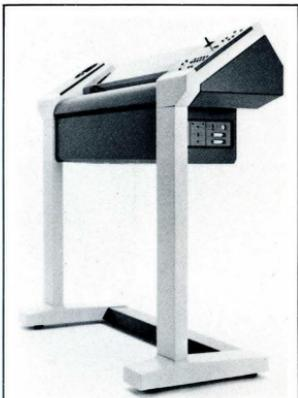
*Per i sistemi di plottaggio più avanzato esistono plotter in grado di disegnare sui fogli di formato A0 ed a velocità che arrivano a 60 centimetri al secondo, come il PLOTTER OCI928 che utilizza 8 penne anche di diversa spessore.*
