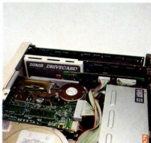
*Le componenti adottate per il funzionamento del Mountain Drivecard fanno trapelare una grossa serietà nella progettazione e nella costruzione della scheda.*
