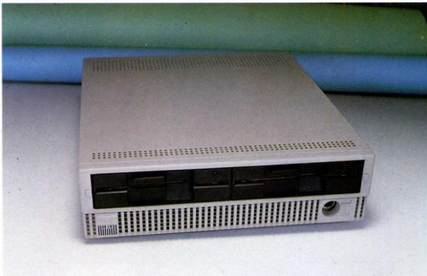
Frontale dell'unità centrale M19. Si noti il connettore sulla sinistra per il collegamento alla tastiera e nella parte superiore i due floppy disk drive da 360 K.
